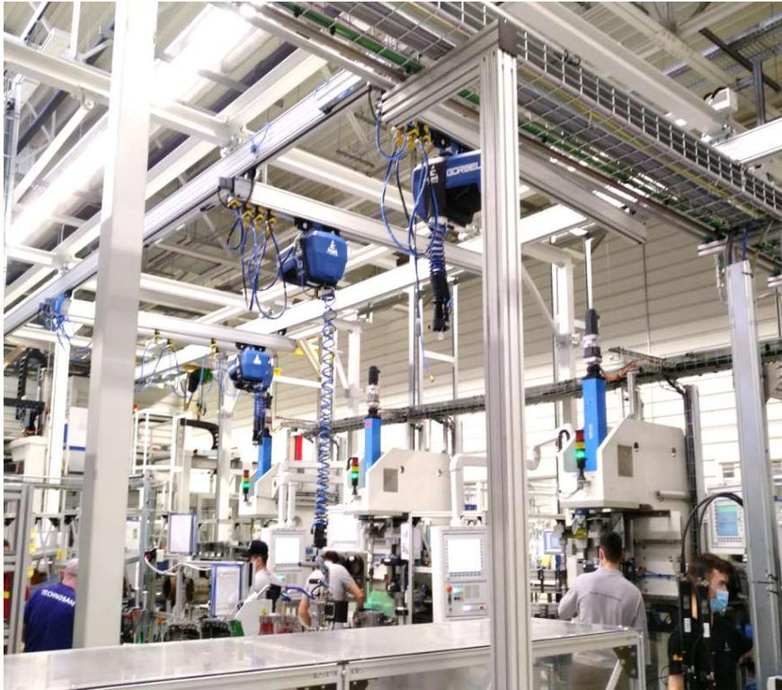
Konzeption, Layout und Montage des freistehenden Aluminium Schienenportal mit 4 Brücken; Medienversorgung: IGUS-Schleppkette und innenliegende Stromversorgung der Kranbahnen.
