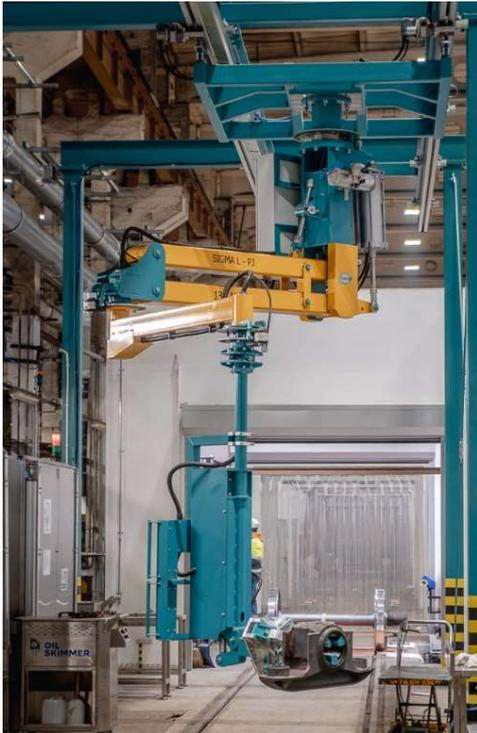
**Knickarm-Manipulator, verfahrbar in Deckenschienensystem Traglast 150 kg, R4000mm, pneumatischer Hub zum Anheben Achsteilen**
