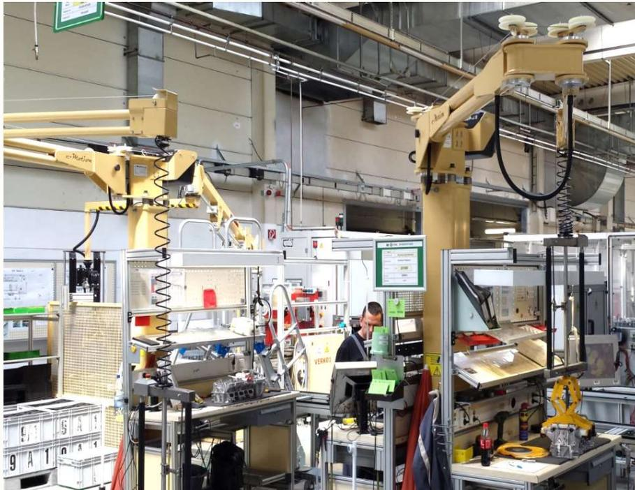
**Knickarm-Manipulatoren mit Drehgriff-Hebehilfe ,
