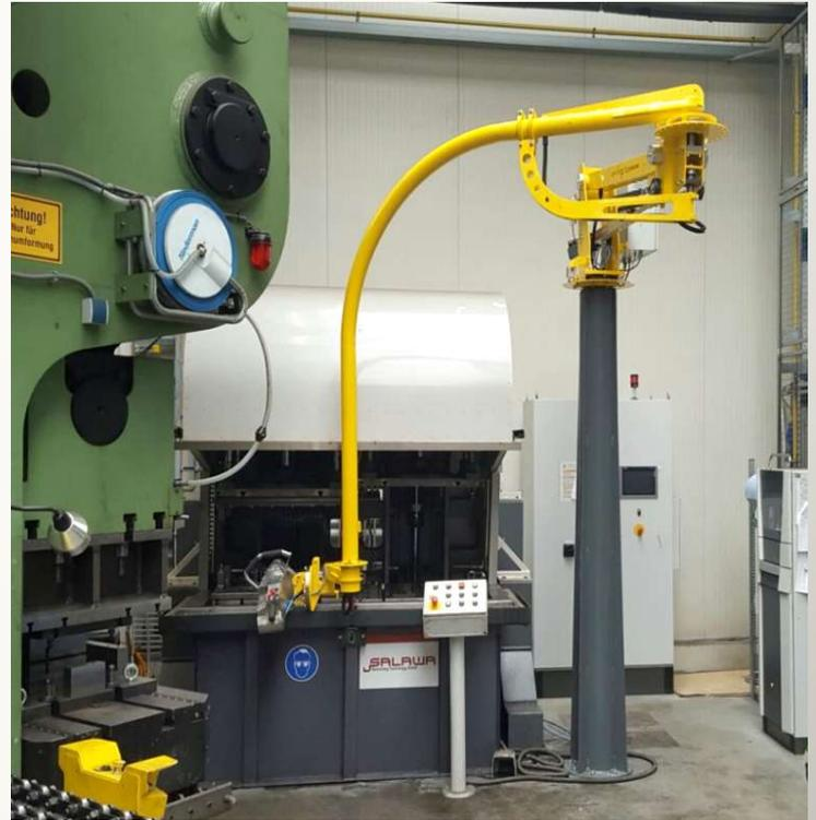
Parallelogramm mit 100 kg Traglast, R=4500 mm, mit
