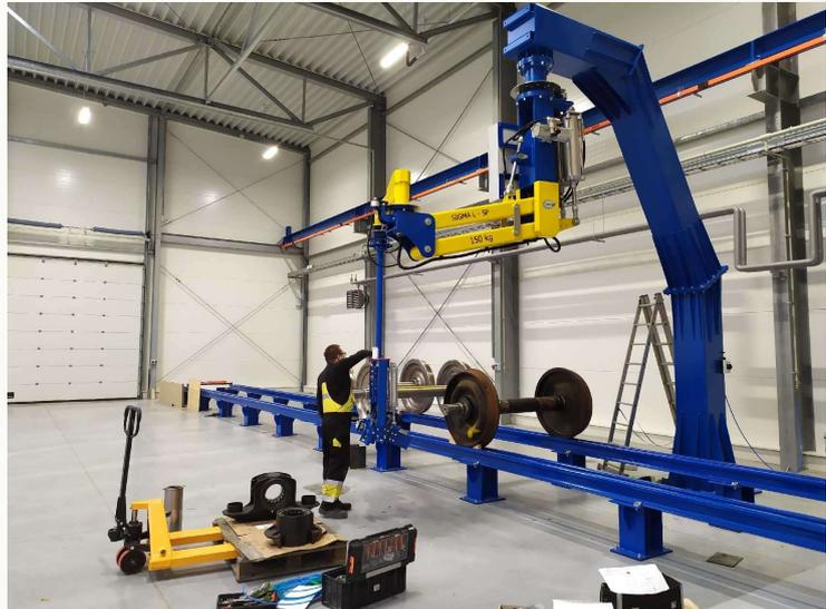
**Knickarm-Manipulator montiert in Stahlgalgen, Traglast 150 kg, R3500mm, pneumatischer Hub zum Anheben von Achsen**
