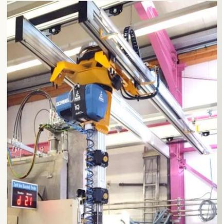
Freistehendes Portal Doppelbrücke zur Aufnahme Z-Achse mit Balancer Antrieb (350 kg)
