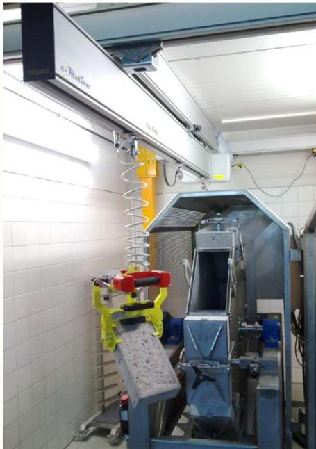
Einbau telekopierende Brücke in Schallschutzkabine zur Steinaufnahme außerhalb der Kabine zur Be- und Entladung der Versuchsanlage.
