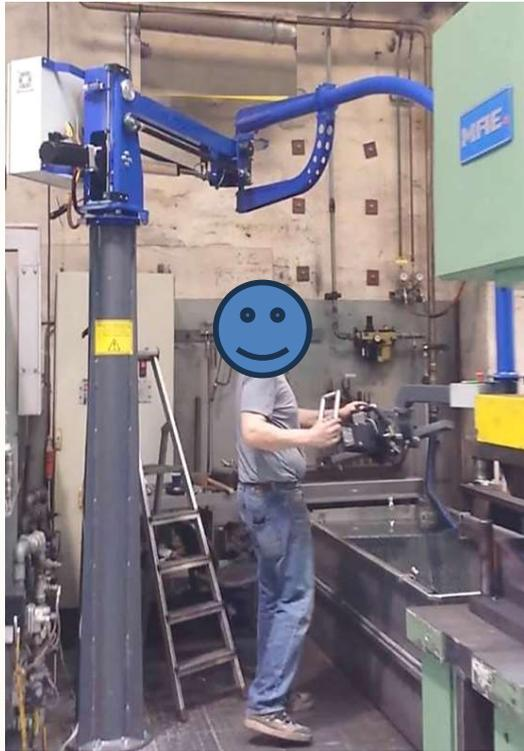
Parallelogramm mit 100 kg Traglast,
