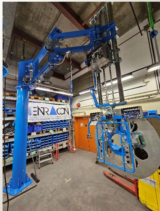
**Knickarm-Manipulator, bodenstationär Traglast 350 kg, R3500mm, pneumatischer Hub zum Anheben von Messerflügeln**
