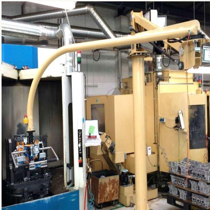
Parallelogramm mit 100 kg Traglast, R=4500mm,
