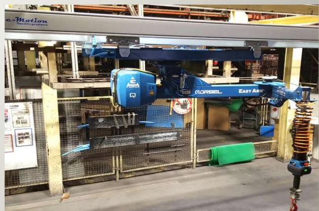
Abhängen des Aluminiumschienenportal mit hängendem Knickarm-Manipulator ; zur Be- und Entladung von Truck-Baugruppen.
