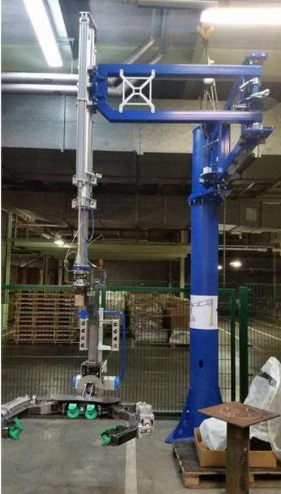
**Knickarm-Manipulator, oben abgebildet die deckenverfahrbare und unten die bodenstationäre Säulenvariante, Traglast 150 kg, R4000mm, pneumatischer Hub zum Anheben von Flugzeugfelgen und/oder Kompletträdern**
