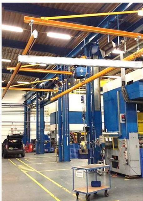
Das Stahl -Aluminiumschienenportal ist an Hallenträger montiert ; belegt keine Betriebsflächen.
